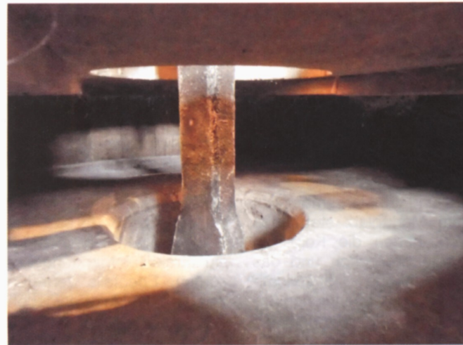
Mühlentechnik ins rechte Licht gesetzt: Mahlgang in der Bütte
