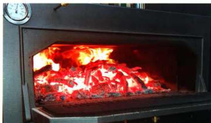
Im Februar muss der Steinofen trockengeheizt und an Temperaturen bis 500 °C adaptiert werden
